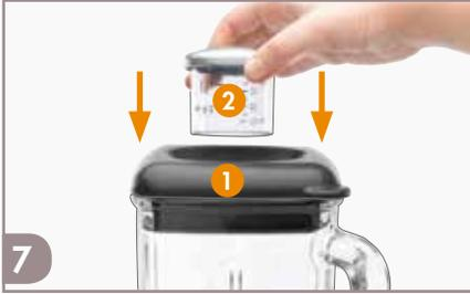
Placez le couvercle et appuyez fermement. Insérez le bouchon doseur. Branchez l'appareil.
