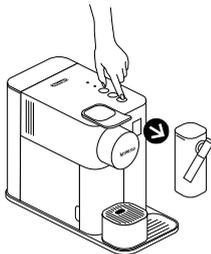
**2** Houd de melkknop 3 seconden ingedrukt om in het menu te komen. De ontkalkings- en reinigingsmeldingen gaan knipperen.
