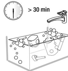
**3** Reinigen Sie das Innere des Milchtanks mit Spülmittel und spülen Sie es mit heißem Wasser (etwa 40 Grad) aus. Nutzen Sie keine scheuernden Mittel oder Materialien, die die Oberfläche des Zubehörs beschädigen könnten.
