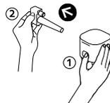
Premere il pulsante sul lato del contenitore e tirare per sbloccare il connettore del sistema Rapid Cappuccino.
