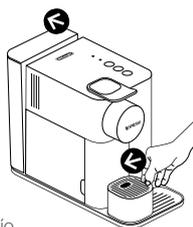
Όταν αποσυσκευάζετε τη μηχανή, αφαιρέστε την πλαστική ταινία, από το δοχείο νερού, το δίσκο αποστράγγισης και το δοχείο καψουλών. Ρυθμίστε το μήκος του καλωδίου και αποθηκεύστε αυτό που περισσεύει στον οδηγό του καλωδίου κάτω από τη μηχανή.
