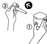
Appuyez sur le bouton situé sur le côté du pot à lait et tirez pour déverrouiller le connecteur du Rapid Cappuccino System.
