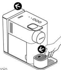
Quando si apre l'imballo della macchina, rimuovere la pellicola di plastica, il serbatoio dell'acqua, il vassoio raccogliogocce e il contenitore delle capsule usate. Regolare la lunghezza del cavo e fissare quello in eccesso nell'apposito vano sotto la macchina.
