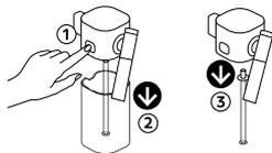
Retirez le réservoir de lait en appuyant sur le bouton situé sur le côté du pot à lait. Débranchez le tube d'aspiration.
