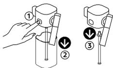
Rimuovere il contenitore del latte premendo il pulsante sul lato e staccare il tubicino di aspirazione del latte.
